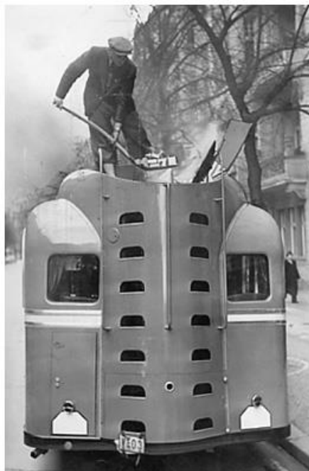
Een echte gaswagen: Autobus met Holzgasgenerator (1940).
